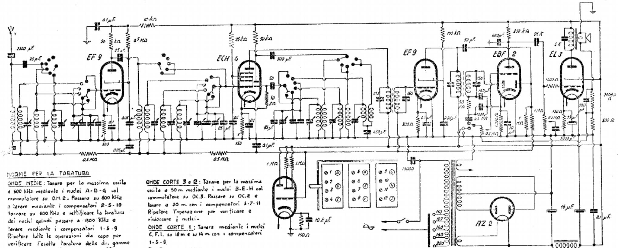
SIMPLEX RADIO - Mod. 165 - Medic e due corte. Media frequenza 460 kc. Potenza d'uscita 5 watt.
